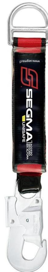
La amortiguación se produce gracias a un desgarramiento progresivo de costuras de nylon especialmente diseñadas para frenar secuencialmente la caída y que se encuentran al interior del equipo.
