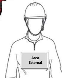
La argolla esternal está especialmente diseñada para conectar un dispositivo anticaídas automático de progresión vertical. Diseñado para progresión en torres de telecomunicaciones, de alta tensión y en todo trayecto ascendente o lateral que requiera protección permanente ante los riesgos de trabajos en altura.
