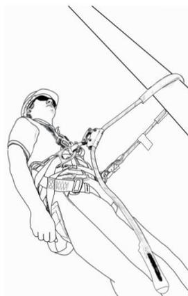
El cabo de sujeción Protec está recomendado sólo para funciones de posicionamiento y no debe utilizarse, bajo ninguna circunstancia, como elemento anticaídas.
